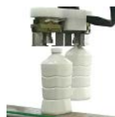
Prelievo dalla linea [Sistema brevettato]
