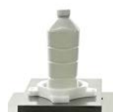
Misura volume di riempimento [Bilancia certificata]
