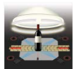
Principio - cupola per illuminazione uniforme
